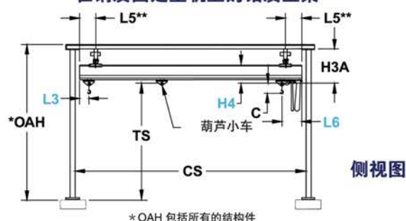
钢质固定型轨上的已开口的铝质主梁
